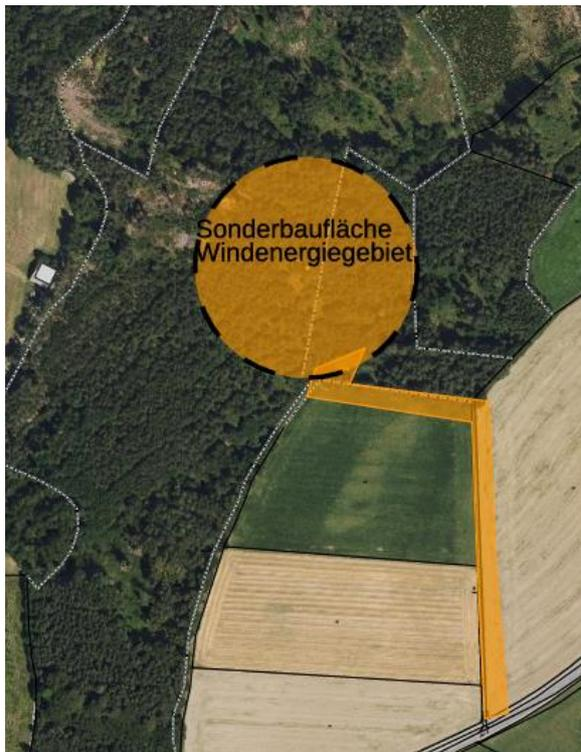
Gemäß § 2 Nr. 2 WindBG festgelegt, dass die Rotorblätter innerhalb der ausgewiesenen Fläche liegen müssen (Rotor-innerhalb-Flächen).
